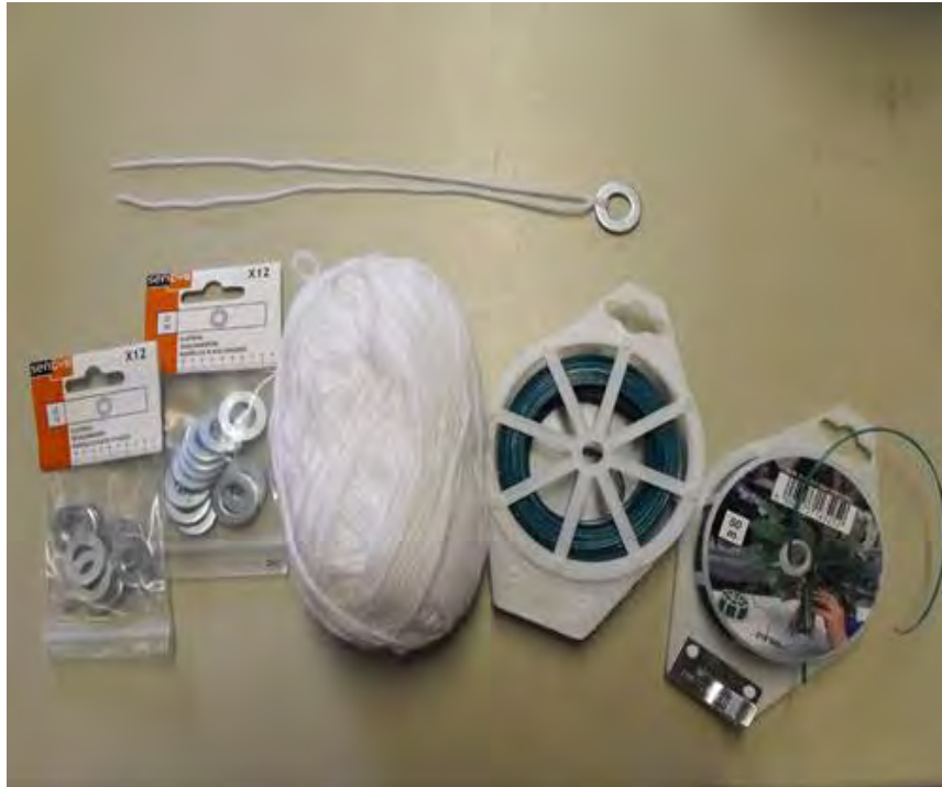
Figuur 18: Materiaal gebruikt voor het uithangen van acrylwol als artificieel substraat, met bovenaan een illustratie van de bevestigingswijze van de acrylwoldraden.
